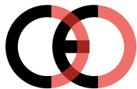
Falsche CE-Kennzeichnung (zu dicht)
