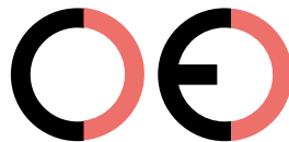
Falsche CE-Kennzeichnung (zu großer Zwischenraum)
